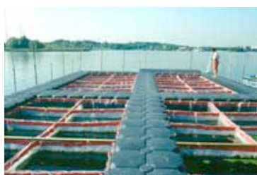
Ponton expérimental avec mécosmes, Lac de Créteil (banlieue parisienne, France)
